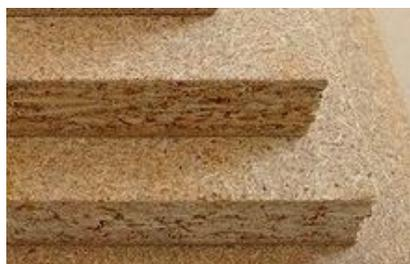
Листовой композиционный материал, изготовленный путем горячего прессования древесных частиц, смешанных со связующим веществом неминерального происхождения.
