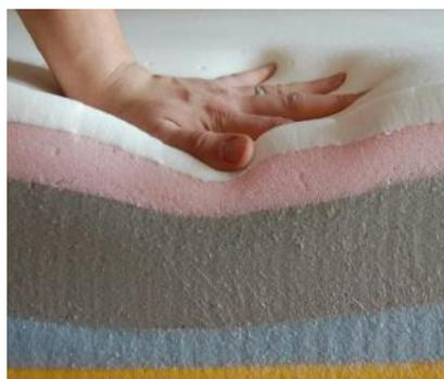
ППУ – вспененный губкообразный материал, полученный путем смешивания нескольких синтетических полимеров. Особенность современных пенополиуретанов – высокие физико-механические свойства. Эластичность PURE ECO FOAM на 20 % выше обычного ППУ.
