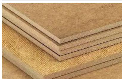
Листовой материал, изготовленный путем горячего прессования или сушки «ковра» из древесных волокон.
