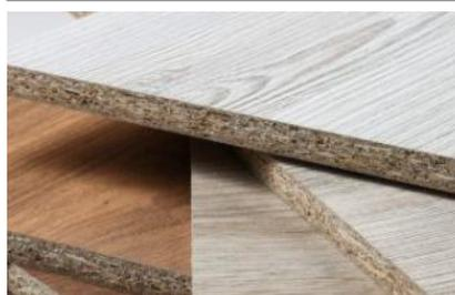
Плита древесно-стружечная, облицованная пленками на основе термореактивных полимеров.
